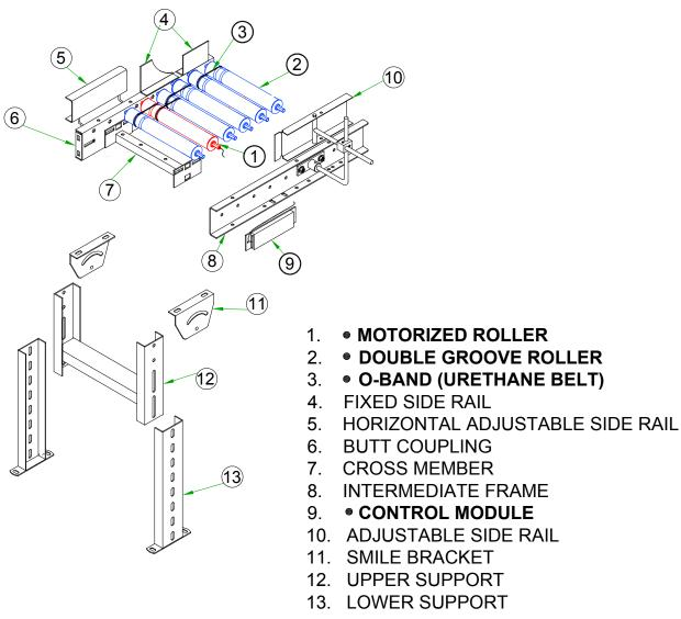
• RECOMMENDED SPARE PARTS TO BE STOCKED AT YOUR LOCATION CONVEYORS CONVEYORS
